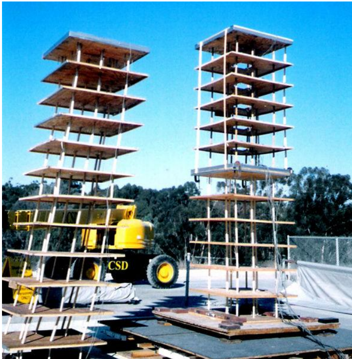
FOTO DE UNA PRUEBA DE AISLAMIENTO DE LA BASE O CIMENTACION
